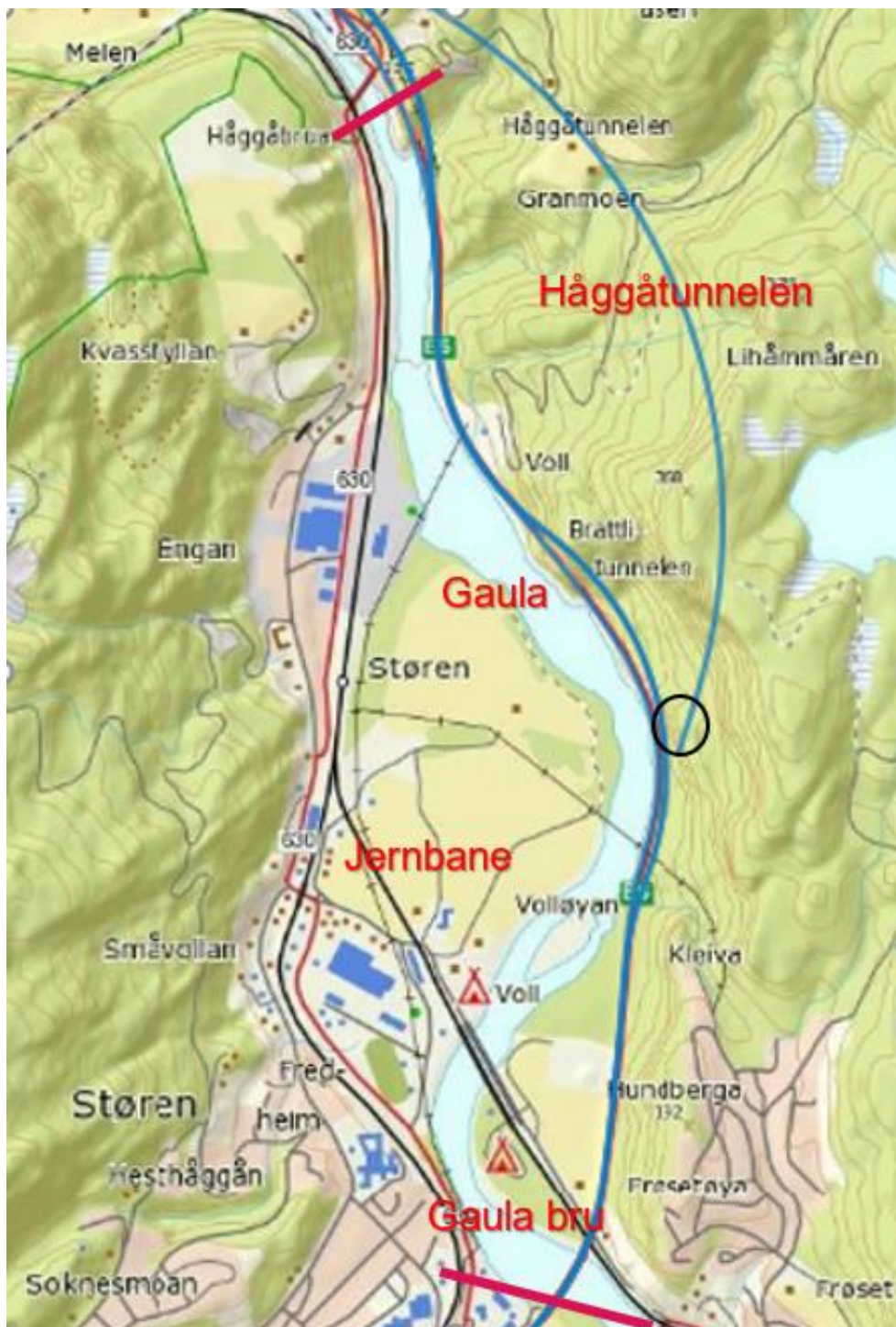
Figur 23: E6 går øst for elva på strekningen Gaula bru til Håggåtunnelen. Alt. 1 er vist med blå strek, tunnel for nordgående felt og dagens E6 for sørgående. Nytt tunnelåpning ved Håggåtunnelen sør er markert med svart sirkel.
